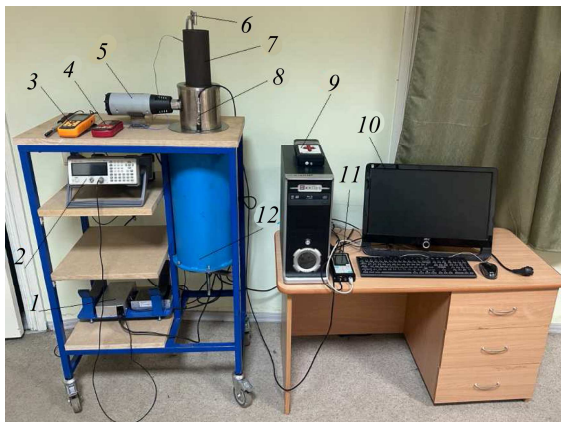
Рис. 1. Общий вид лабораторного стенда: 1 – источник питания; 2 – генератор сигналов; 3 – термоанемометр VENETECH GM8903; 4 – термометр; 5 – источник нагретого воздуха; 6 – датчик термоанемометра ИРВИС; 7 – рабочий участок; 8 – микрофон; 9 – термоанемометр ИРВИС; 10 – персональный компьютер; 11 – измерительный комплекс Экофизика; 12 – резонатор Гельмгольца
