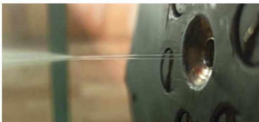
Рис. 1. Столкновение двух струй при истечении при 140\text{ }^{\circ}\text{C}
