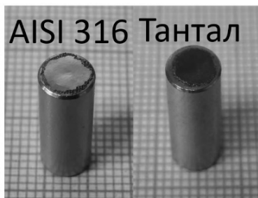
Вид наваренных мембран из AISI 316 и тантала
